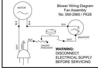
Fig. 15 Blower wiring diagram.
